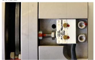
Система контроля срабатывания тормоза с микропереключателем
