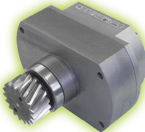
Тормоз ROBA®-pinionstop входит в зацепление в любом месте непосредственно на зубчатой рейке как независимая тормозная система и закрыт в обесточенном состоянии. Этот предохранительный тормоз тем самым обеспечивает высокий уровень безопасности при сбоях в электропитании или аварийном отключении, а также в ходе работ по монтажу и техобслуживанию.
