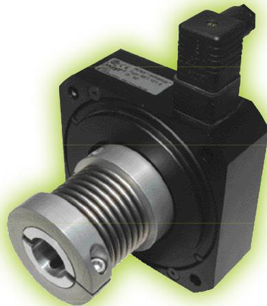
ROBA®-alphastop® - предохранительный тормоз, установленный между серводвигателем и защитным колпаком. Зубчатая втулка тормоза объединена с беззазорной муфтой с металлическим сильфоном smartflex®. Фрикционные зажимные кольца обеспечивают беззазорную передачу крутящего момента между двигателем и шарико-винтовой парой. Для монтажа непосредственно на приводе с полым валом тормоз ROBA®-alphastop® оснащается выходным валом, который исключает необходимость соединительной муфты.
